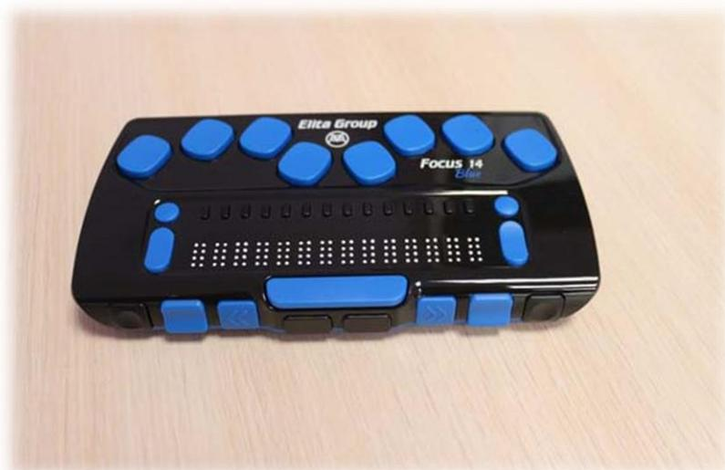
Ультрапортативный тактильный дисплей Брайля с беспроводной технологией Bluetooth, обеспечивает комфортную работу и доступность информации на компьютере.
