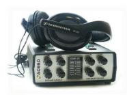
Предназначен для отработки речевых навыков людей с нарушением слуха. В комплекте к прибору идут наушники и два микрофона. Один микрофон для обучающегося, другой для преподавателя. Прибор может использоваться, как звукоусиливающая аппаратура, что улучшает коммуникацию между преподавателем и студентом.
