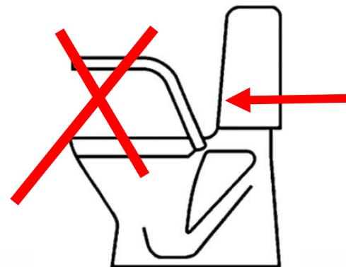
Поручни, установленные на унитазе могут применяться только для индивидуального использования с учетом веса пользователя и допустимой нагрузки на них, указанной в инструкции.
