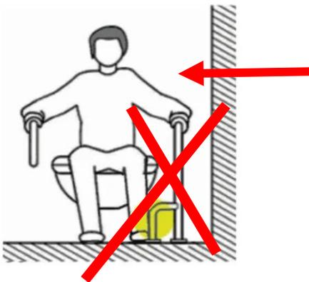
Недопустимо разворачивать дополнительную опору поручня в сторону унитаза, это создает травмоопасную ситуацию при вставании. За выступающие в зону движения опоры поручня можно зацепиться ногой и упасть.
