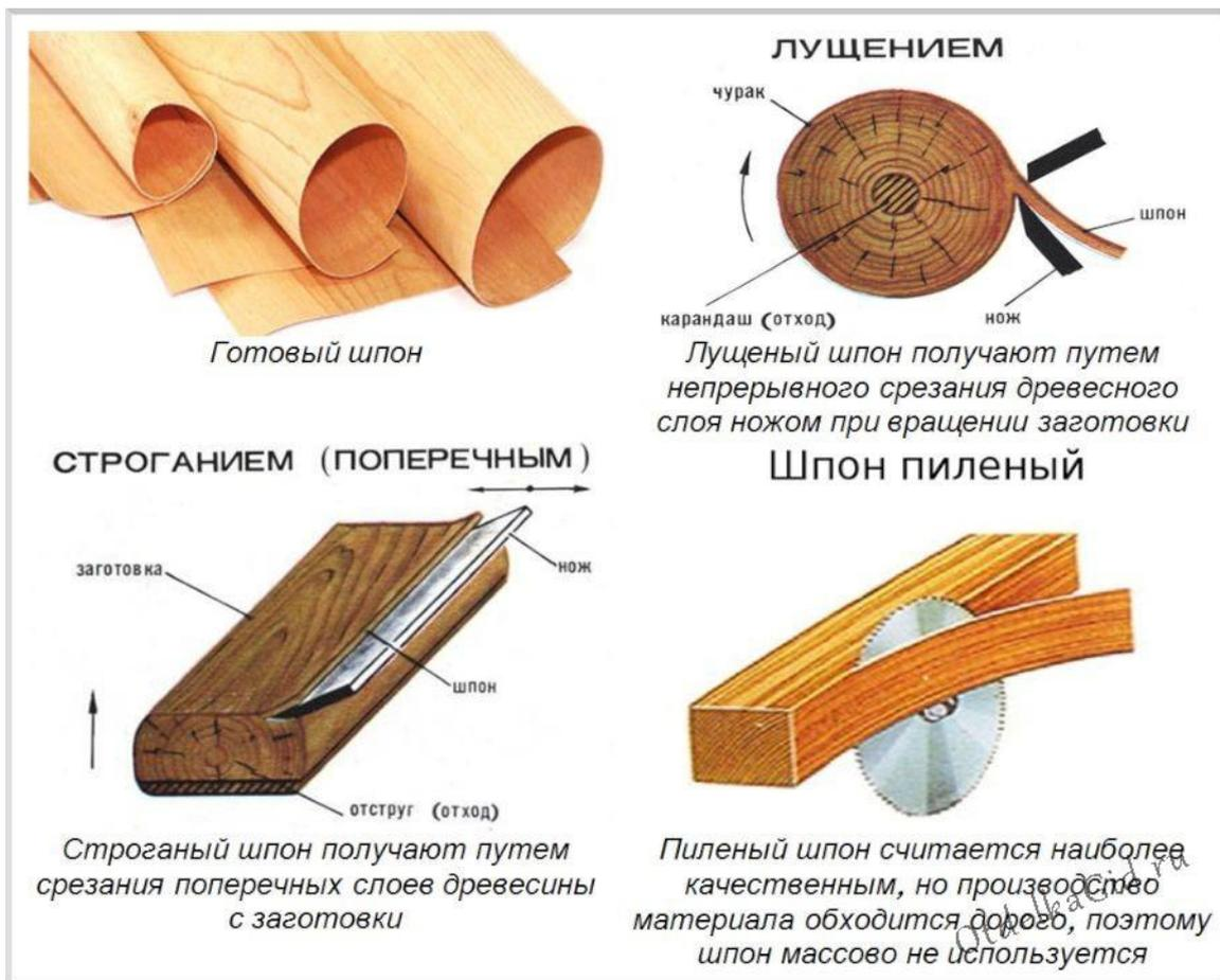
**Рисунок 1. Способы изготовления шпона**
