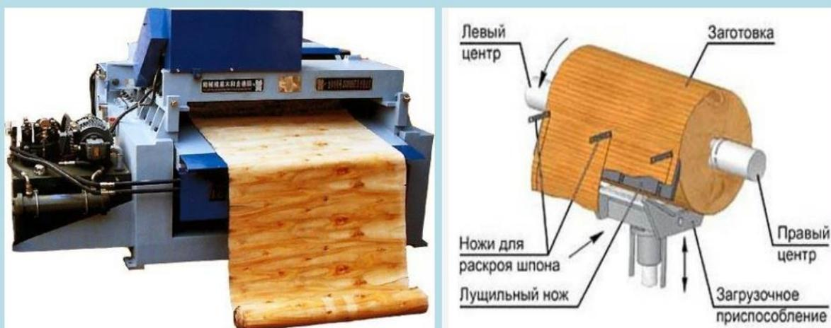
Рисунок 3. Процесс лущения на луцильном станке
