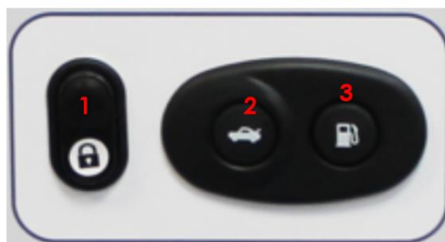
Рисунок 2– Панель управления: 1 – кнопка разблокировки / блокировки двери; 2 – кнопка открывания замка багажника; 3 – кнопка открывания лючка бензобака.
